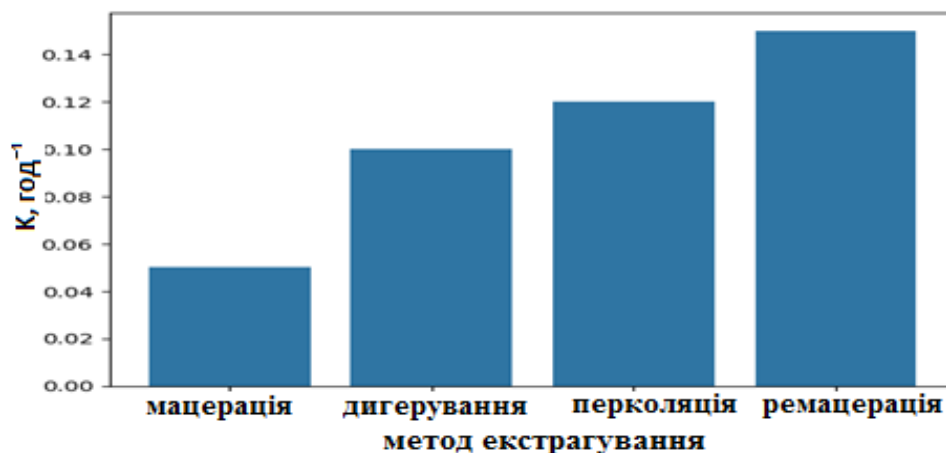
Рис. 3. Порівняння загального коефіцієнта масопередачі K для різних методів екстрагування
